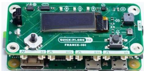
La photo ci-contre montre un tel objet connecté, constitué d'un tout petit ordinateur, appelé *Raspberry Pi zéro*, assemblé avec une carte contenant plusieurs *capteurs* et *actionneurs*.
